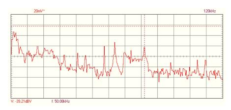
Spectre après allumage de l'ampoule. On constate une bosse dans la bande concernée (40-50KHz)
